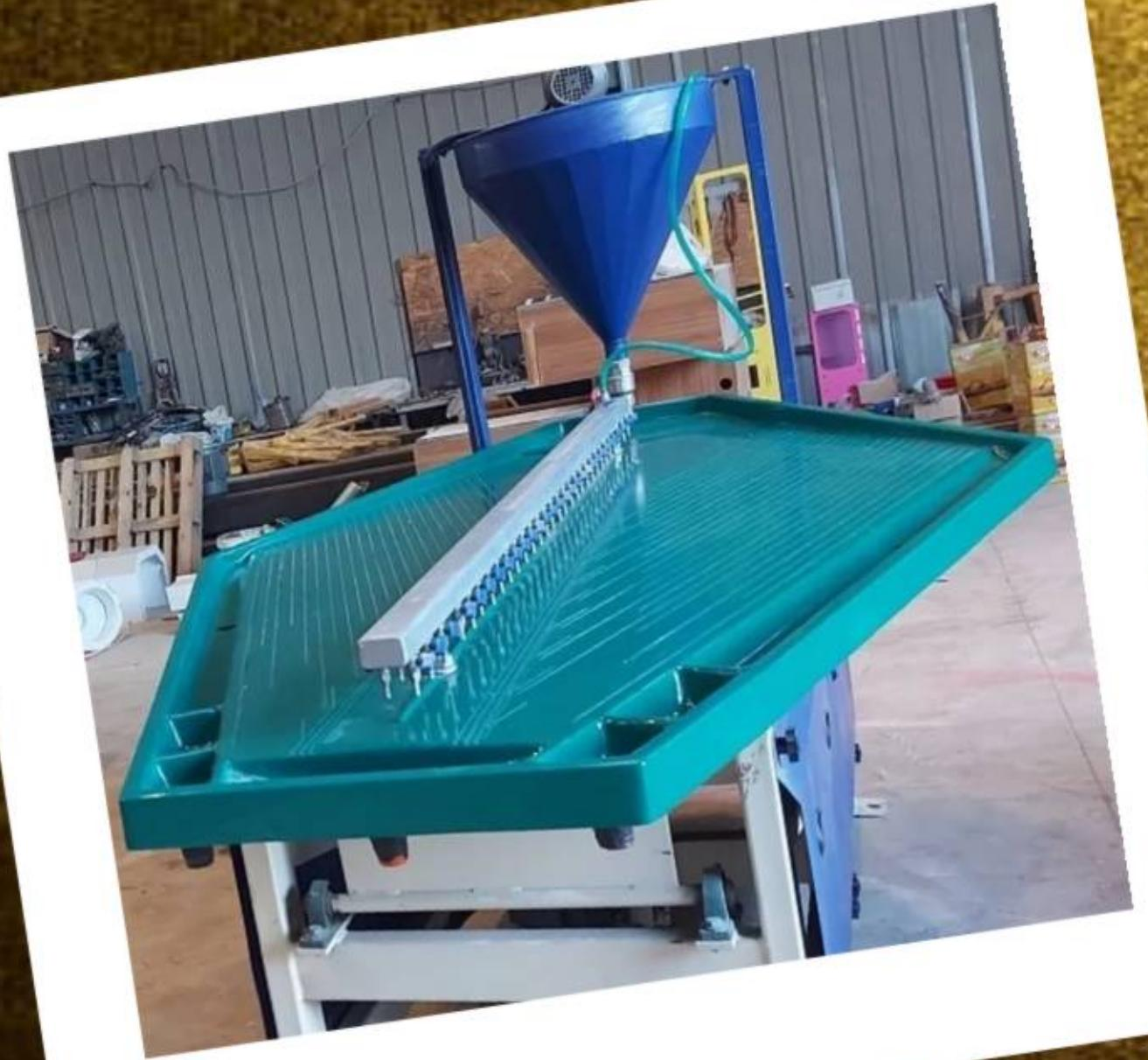
Gemini masa , ince Altının doğrudan geri kazanılması için özel olarak tasarlanmıştır. Direk tahrik sistemi, masaya bağlı bir krank ve mili tahrik eden motor içerir. Krank, titreşimi emmek için yaylı bir bağlantı sistemi içerir. Darbe durdurma sistemi ise ince ayar yapmanıza olanağ sağlar. Tek bir vida ile tablaya hassas ayar yapabilirsiniz.
