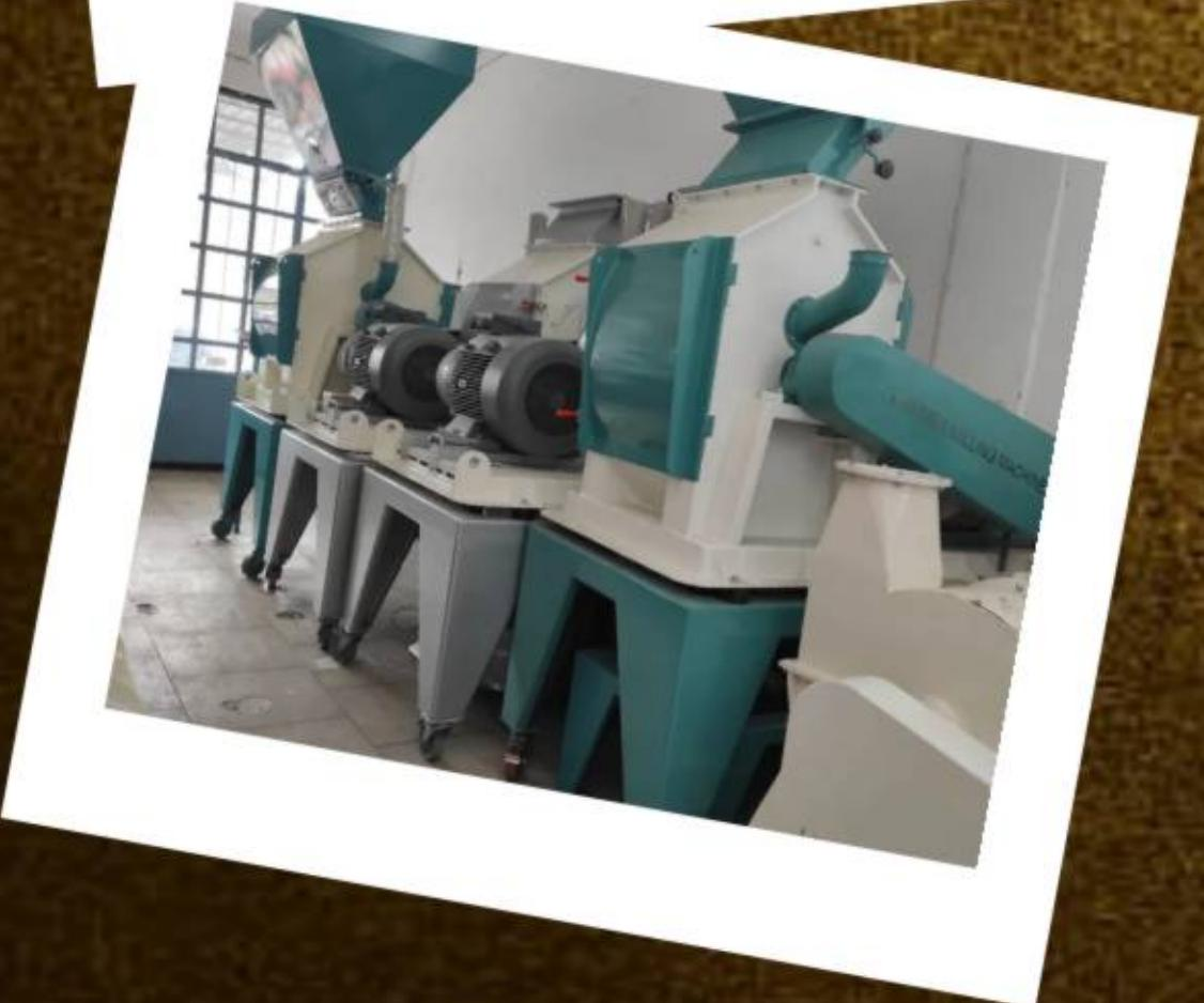
**H serisi kırcılar aynı tipte ve farklı kapasitelerde üretilen standart bir çekiçli kırcı modelidir. Genel amaçlı kullanıma yönelik üretilmiş olup kaolin, talk, mermer, grafit, kuvars gibi farklı sertlikteki kayaçlar için uygundur.**
